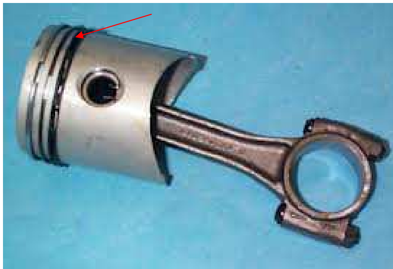
Figura: Conjunto biela / pistón en cuya parte exterior se aprecian los segmentos objeto del estudio.
