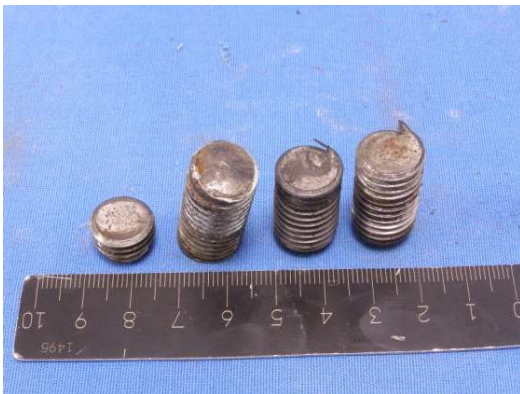
Figura 1: Estado de los tornillos tras la rotura.
