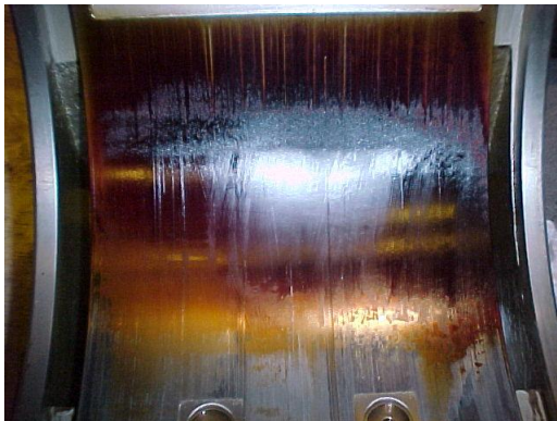
Barniz en un cojinete de turbina
