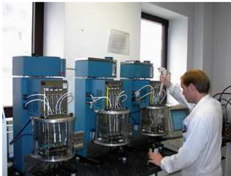
Figura 4. Equipo automático de viscosidad cinemática
